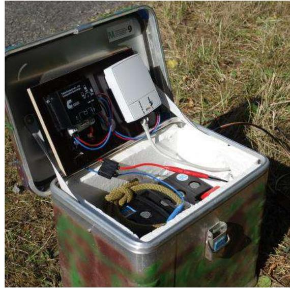
**Abb. 21:** Aluminium Box der Firma Zarges GmbH mit einer Autobatterie sowie senkrecht die Platte mit Tiefentladeschutz und Axis Switch zur Versorgung der Wärmebildkamera mit Strom. Gleichzeitig dient das Switch zum Zugriff auf die Wärmebildkamera mit dem Laptop.
