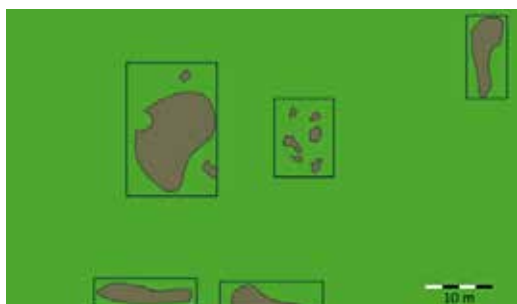
Abb. 68: Die Wildschäden sind mit dem Bereich umrandet, der repariert werden muss. Bedingt durch die Arbeitsbreite der Reparaturmaschinen (z.B. 3 m) ist eine kleinräumigere Reparatur nicht möglich. Es ergeben sich somit fünf Einzelschäden die separat geschätzt werden müssen.
